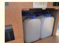
標準ギャレー 10L給排水ポリタンク、電動ポンプ付 ※冷蔵庫上部テーブル標準装備
