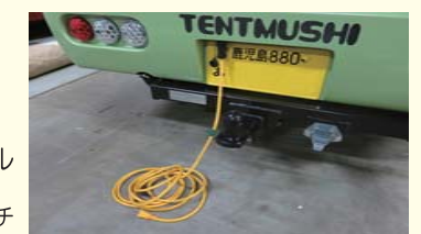
外部AC100V入力ソケット ※外部AC、インバーター電源 自動切替装置付 ※入力時 メイン・サブバッテリー自動充電器付
