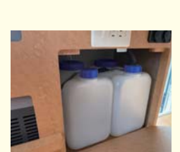
標準ギャレー 10L給排水ポリタンク、電動ポンプ付 ※冷蔵庫上部テーブル標準装備
