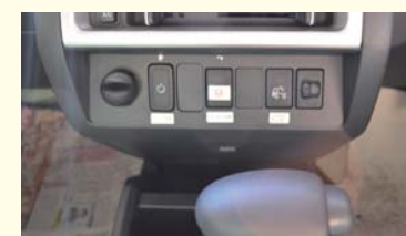
メイン電源スイッチ ※6連スイッチへの電源を運転席でスイッチング出来ます。
