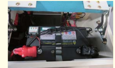
サブバッテリー走行充電システム インバーター1500W ※昇圧タイプ走行充電器使用(サブバッテリーへの入力電圧を上げ高効率充電) ※バッテリー保護のためのプロテクター標準装備
