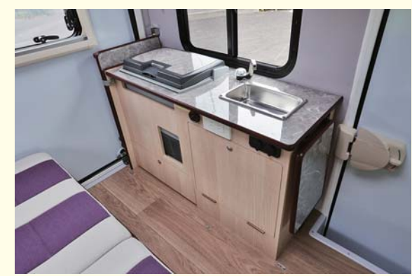
標準ギャレー 10L給排水ポリタンク、電動ポンプ付 ※冷蔵庫上部テーブル標準装備
