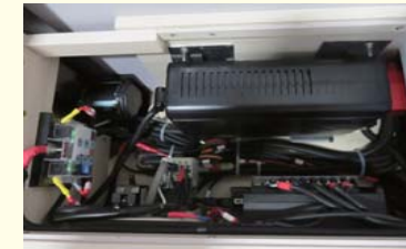
インバーター1500W ※昇圧タイプ走行充電器使用(サブバッテリーへの入力電圧を上げ高効率充電) ※バッテリー保護のためのプロテクター標準装備
